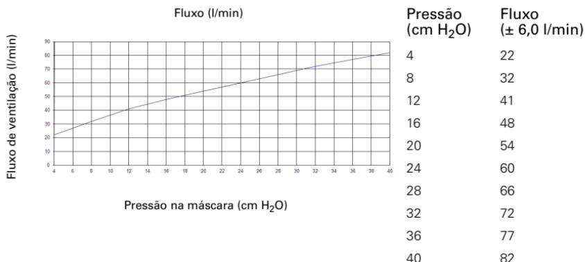
**Nota:** a máscara contém ventilação passiva que atende aos requisitos de proteção contra reinalação definidos na norma ISO 17510-2. Em decorrência de variações na fabricação, a taxa de fluxo do respiradouro pode variar.
