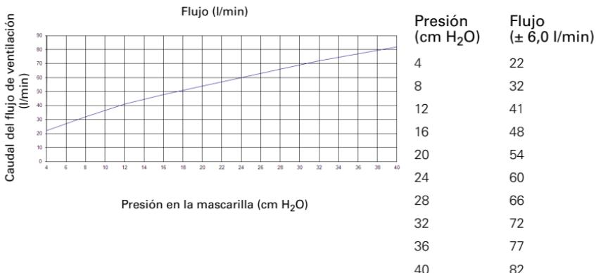
**Nota:** La mascarilla contiene un sistema de ventilación pasiva que satisface los requisitos de protección contra la reinspiración estipulados en la ISO 17510-2. Debido a variaciones en la fabricación, el caudal de ventilación puede variar.
