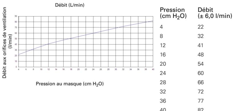
**Remarque :** Le masque possède un système de ventilation passive conforme à la norme ISO 17510-2 en matière de protection contre la réinhalation. En raison des variations de fabrication, le débit aux orifices de ventilation peut varier.
